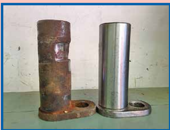
När framaxeltappen ser ut så här har det varit dags att byta för länge sedan.
