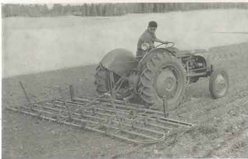
På skorpbildande jordar måste skorpan snarast brytas för att förhindra uttorkning av markfuktigheten. Detta sker bäst med en sladdharv eller den avbildade lättharven, vilka båda kan erhållas hos Ferguson-försäljare över hela Sverige.
