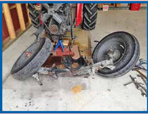
För den som undrar, så är klammorna på framaxeln fästen för vajrar och kryssstag till bommen på snöplögen.
