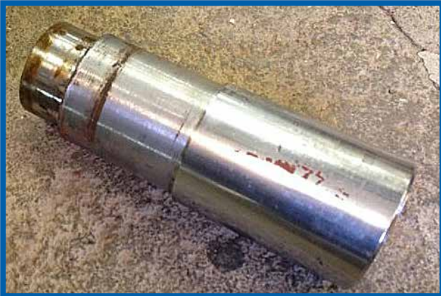
Specialtillverkat drivdorn för att knacka ut bussningen.
