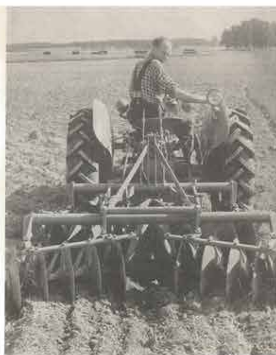
Tallrikskharven är ett utmärkt redskap för bearbetning av våra moss- och torvjordar liksom också gytte- och dyjordar.
