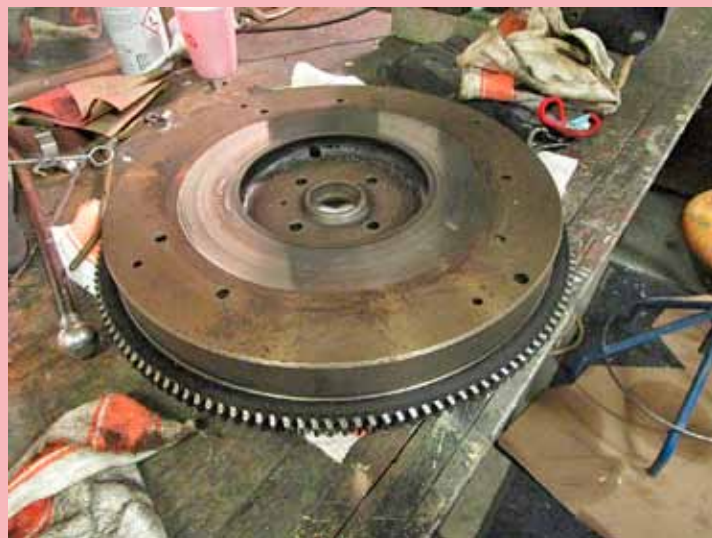
Svänghjul med kuggkrans.
