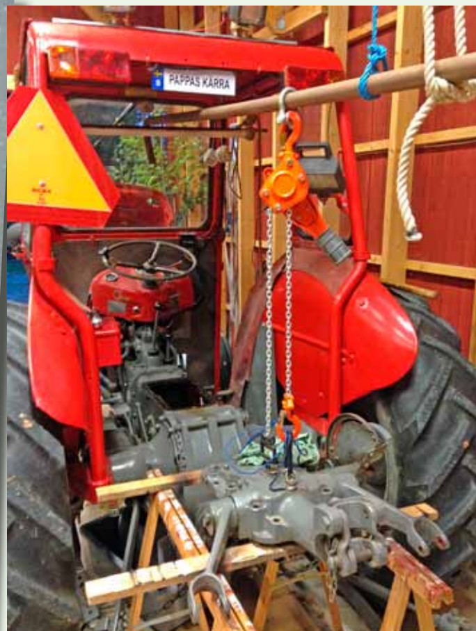
Sänk ner locket när det är ute ur traktorn. Ställ ett par bockar med brädor emellan att ställa ner locket på.
