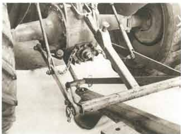
Med denna helautomatiska kopplingsanordning, som helt manövreras med hjälp av hydrauliska systemets regleringspåk, kan föraren till- och fränkoppla släpvagnen eller maskinen med motsvarande dragbom utan att lämna förarsätet (lägg märke till att det är dragkroken, som kopplas ur ögla på dragbommen med stödplattan).
