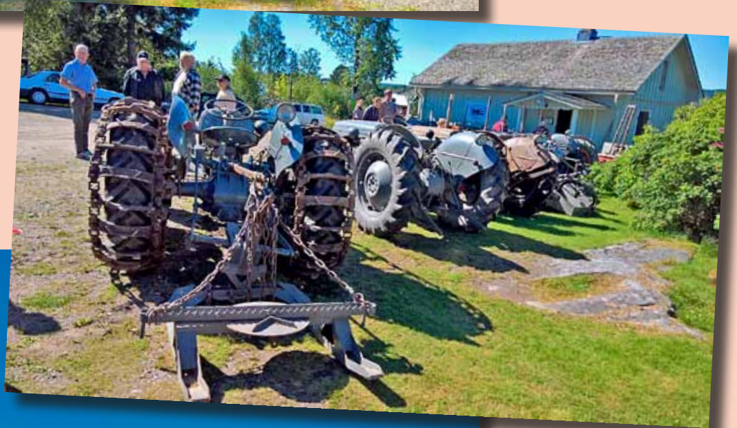
Närmast i bild en skogs- utrustad Grälle med halv- band och lunningskälke.
