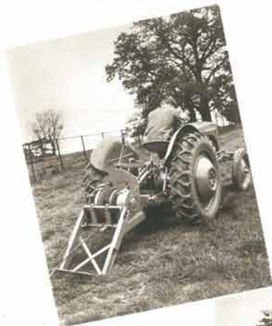
Vinschen är snabbt och behändigt kopplad till trepunktsfästena.
