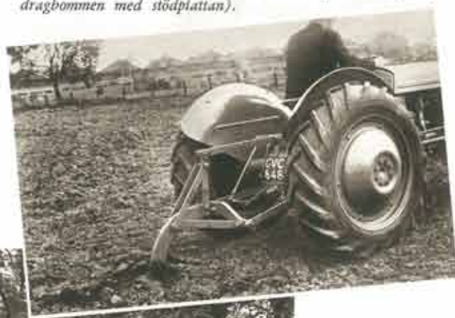
Med denna helautomatiska kopplingsanordning, som helt manövreras med hjälp av hydrauliska systemets regleringspåk, kan föraren till- och fränkoppla släpvagnen eller maskinen med motsvarande dragbom utan att lämna förarsätet (lägg märke till att det är dragkroken, som kopplas ur ögla på dragbommen med stödplattan).
