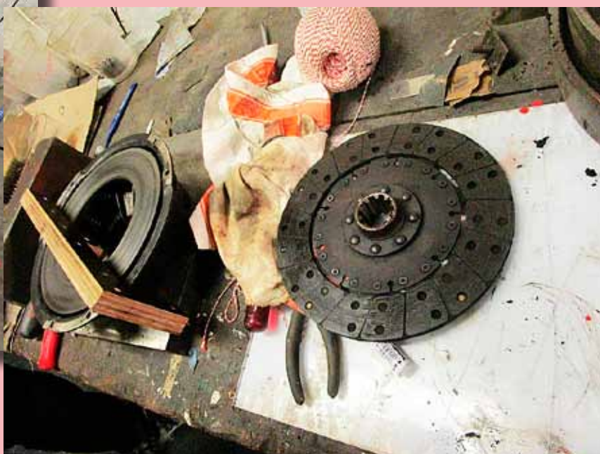
Tryckplatta med lameller.
