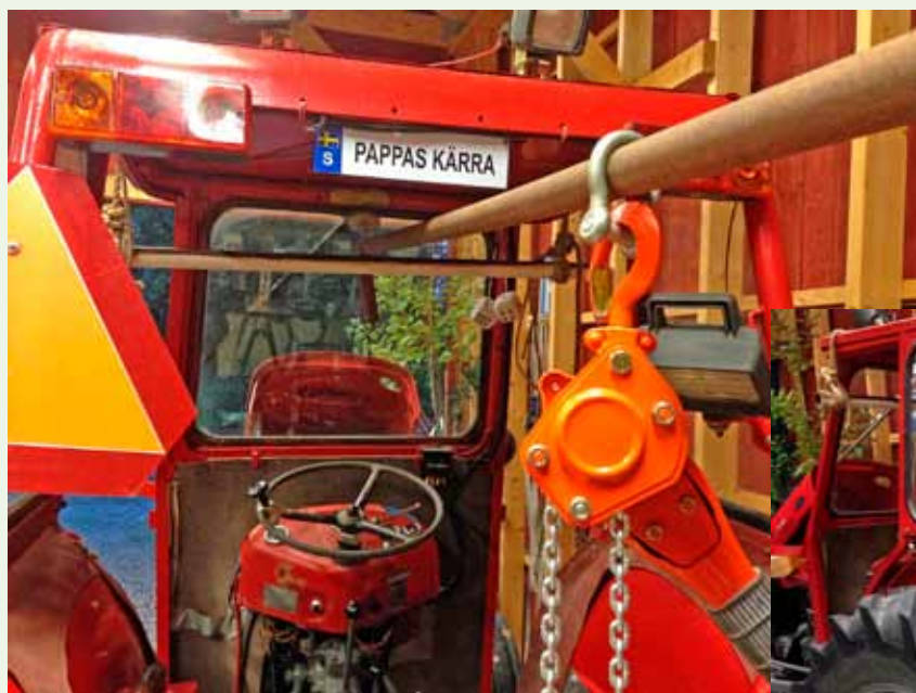
Rälsen för lyftspelet som består av två rör som bildar ett T.
